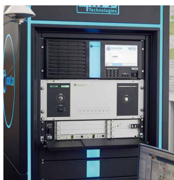
▲ Система хранит в себе информацию о параметрах ЛЭП и электросети и оперативно передает информацию вычислений расстояния до повреждения на основе параметров аварийного режима
