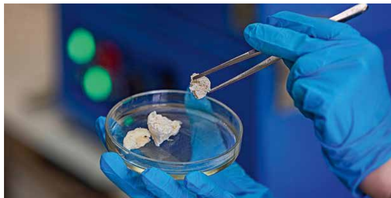
▲ Биополимер на основе крахмала и хитозана полностью перерабатывается менее чем за месяц
