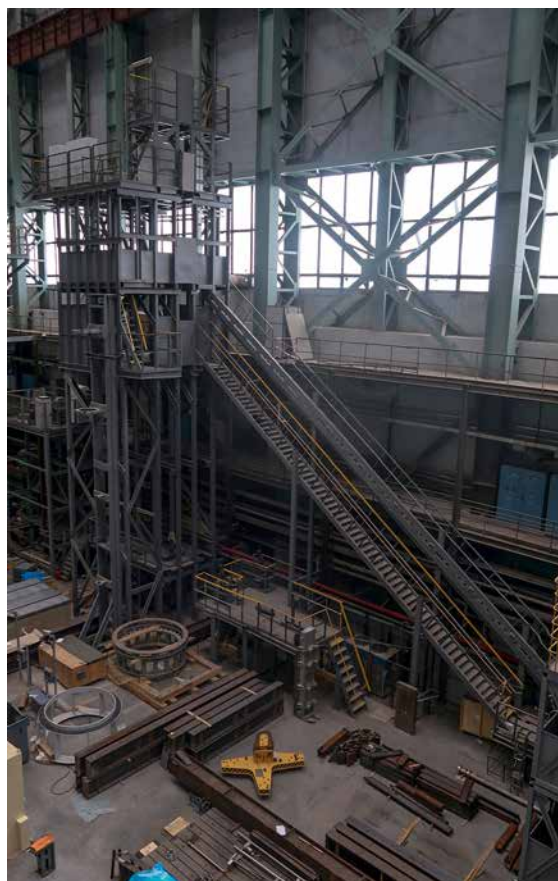
◀ Подъемники предназначены для транспортирования отработавших тепловыделяющих сборок, герметичных пеналов, гильз системы управления защиты с захватами, стержней СУЗ с пеналами и сборок стальной и борной защиты
