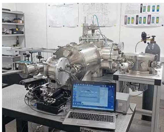
Рис. 1. Стенд лазерно-плазменного источника литографа на длину волны 11,2 нм
